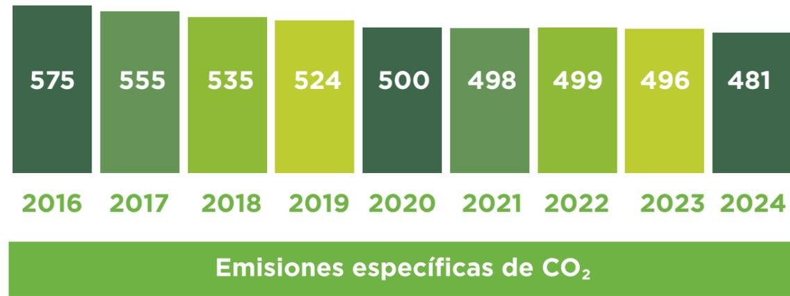
Como indica el gráfico, desde 2016 se observa una disminución significativa en las emisiones específicas de CO<sub>2</sub>. Este avance se debe principalmente a dos acciones claves: la reducción sostenida del factor clínker/cemento y el aumento considerable en el porcentaje de sustitución térmica mediante combustibles alternativos.
