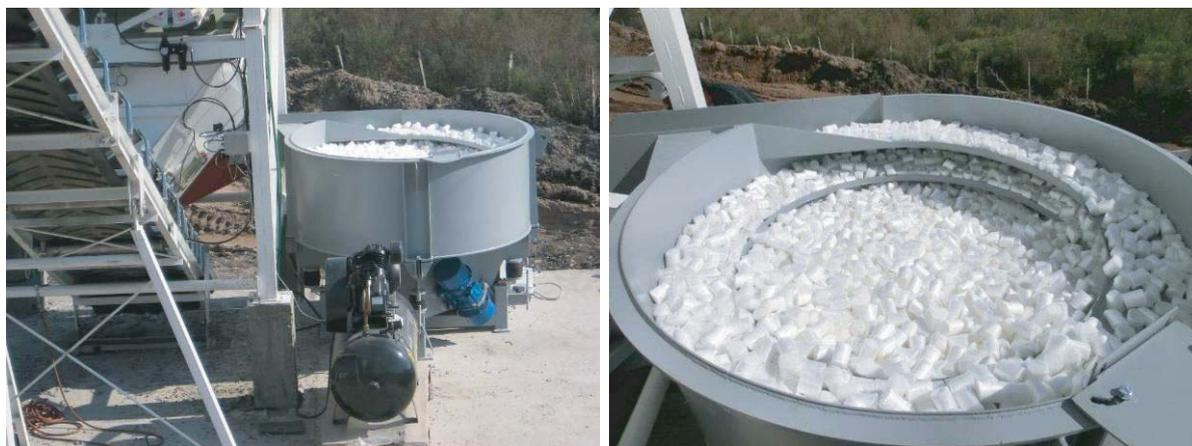
Fig. 6. Dosificador automático de las macro fibras, instalado en la planta de hormigón.
