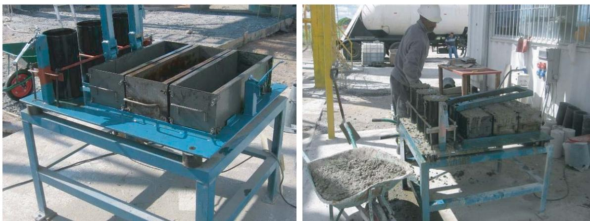
**Fig. 11.** Mesa vibratoria instalada al pie de la planta para el moldeo de probetas.
