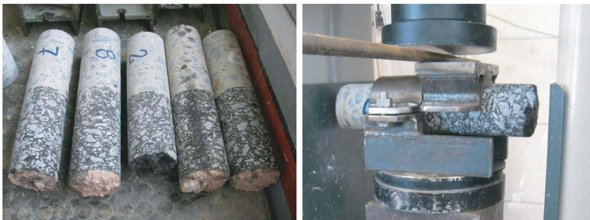
**Fig. 13.** Ensayo de adherencia por resistencia al corte en la zona de la interfaz HRF-asfalto.
