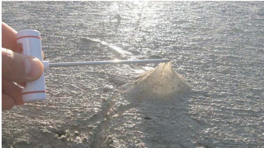
**Fig. 9.** Detalle de la formación de la membrana de curado en base a solvente.
