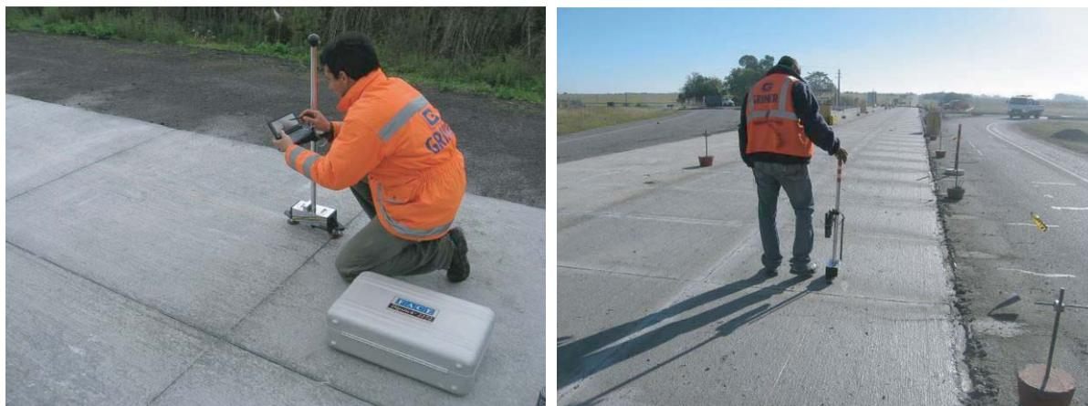
**Fig. 14.** Registro de la regularidad superficial mediante el uso de un perfilómetro pivotante.
