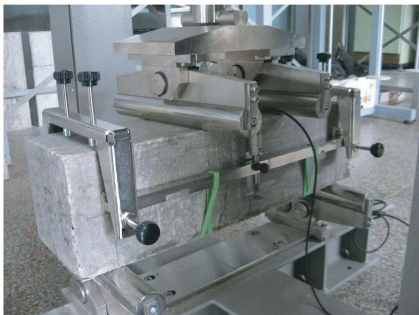
**Fig. 12.** Dispositivo de ensayo adquirido, para determinar la resistencia residual del HRF.
