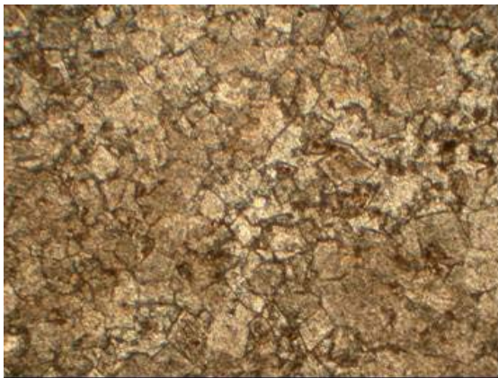
Fotografía 3. Romboedros de dolomita (25 \mu\text{m} a 75 \mu\text{m} ), con cuarzo microcristalino (< 20 \mu\text{m} ). Sin analizador (x 400)
