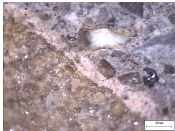
Fotografía 6. Aspecto de la zona de interfase dolomía-mortero de un prisma de hormigón IRAM 1700 (edad: 8 años)
