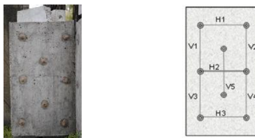
Figura 3: Vista de un bloque de hormigón y esquema de las mediciones de deformación.
