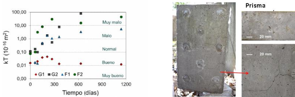
Figura 7: Evolución de la permeabilidad y detalle de fisuras sobre un prototipo y un prisma de G2.
